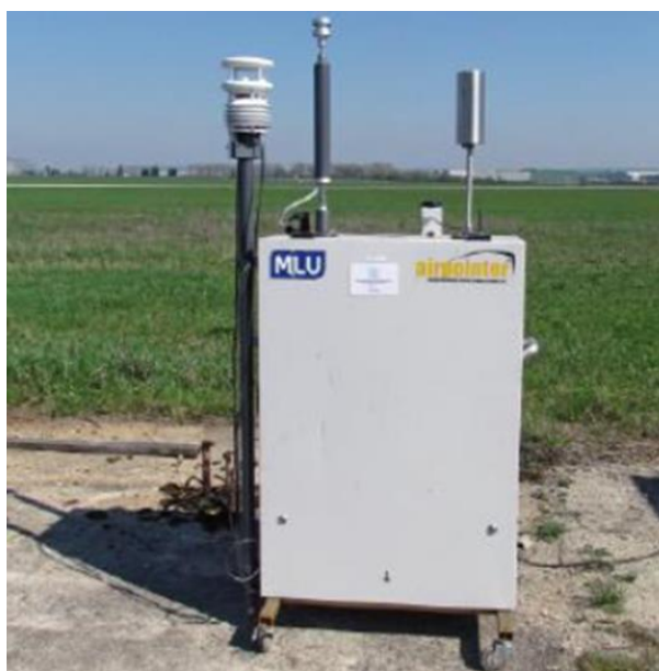
Obr. 7: Měřící technika využitá při souměření – vlevo Airpointer (Recordum Messtechnik GmbH, Rakousko), vpravo odběrové zařízení Sven Leckel MVS6 a SEQ47/50
