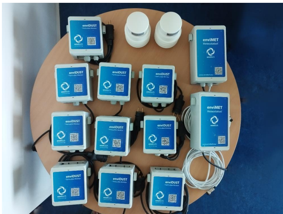
Obr. 6: Senzorické jednotky enviDUST (vlevo), meteostanice enviMET (vpravo)
