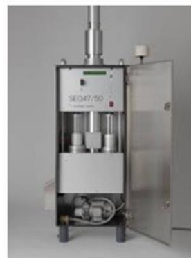
Obr. 7: Měřící technika využitá při souměření – vlevo Airpointer (Recordum Messtechnik GmbH, Rakousko), vpravo odběrové zařízení Sven Leckel MVS6 a SEQ47/50
